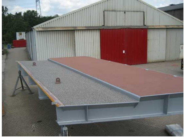
(verkeersbrug gereed, voorzien van polyurethan coating en slijtlaag)
